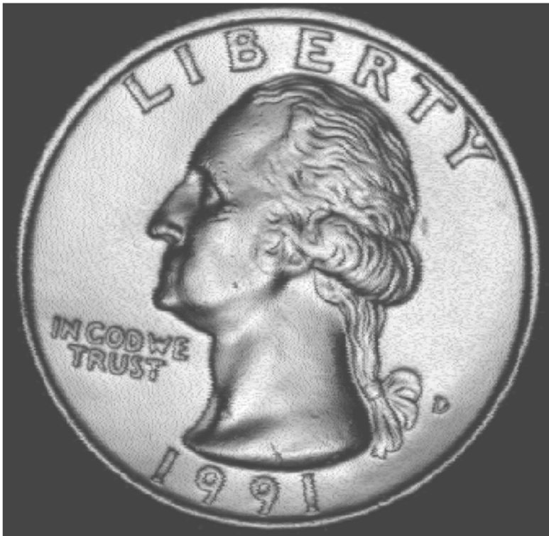
Imagen producida usando el sonido reflejado desde la cara frontal de la moneda.
