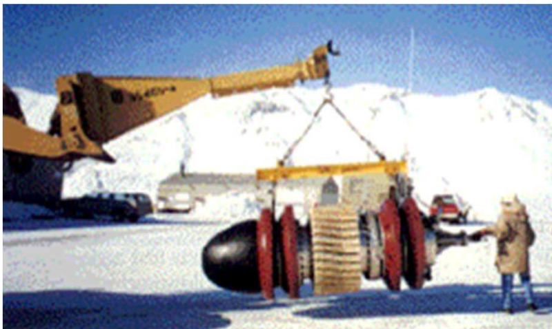
Inspección por dispersión de flujo.
