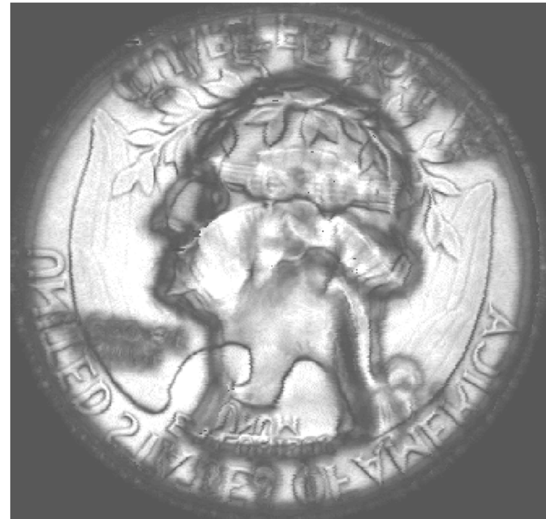
Imagen producida usando el sonido reflejado por la cara inferior de la moneda (inspeccionada desde la "cara")
