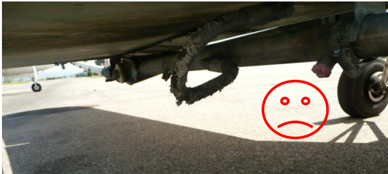
Figura 16. Tubería en mal estado que puede ocasionar fugas bajo presión del caldo.
