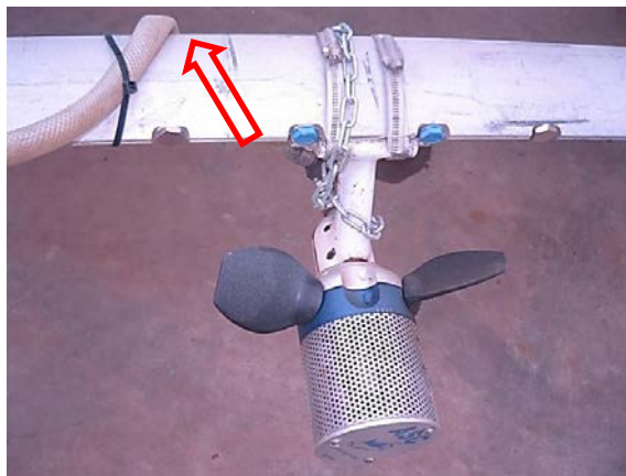
Figura 17. Tubería aplastada en el perfil de la pértiga que dificulta el paso de líquido hacia la boquilla (atomizador).
