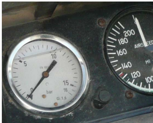
Figura 14. Manómetro con resolución de escala cada 0,5 bares, no apropiado para trabajar a presiones inferiores a 7 bares.
