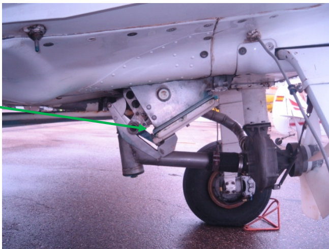
Figura 5. Trampa de emergencia de vaciado sin fugas.
