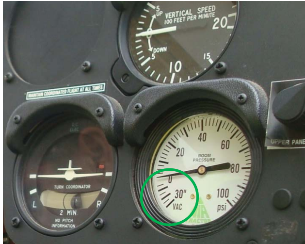
Figura 15. Manómetro correcto, con valores negativos (indican cuándo la pértiga soporta el vacío por aspiración) y escala adecuada para pulverizaciones con presiones de trabajo menores a 5 bar (divisiones cada 2 PSI, equivalente a 0,14 bar).
