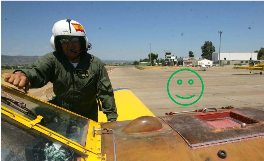
Figura 9. Comprobación del cierre estanco de la boca de llenado superior del depósito.
