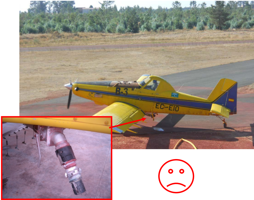
Figura 10. Válvula lateral de llenado del depósito sin fugas pero con escape de líquido en el desacople.
