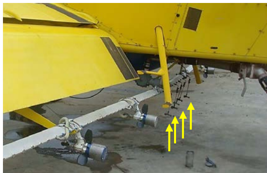
Figura 24. Boquillas centrífugas (accionadas por flujo de aire en la pértiga) y complementadas bajo la base de la aeronave (zona de interferencia de la bomba de molinete) por boquillas hidráulicas.
