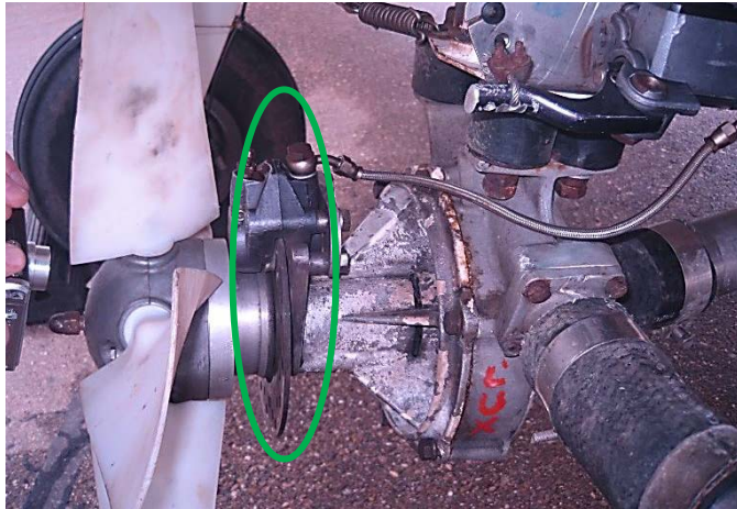
Figura 12. Sistema de frenos de disco montados en el eje del molinete que acciona la bomba para interrumpir su giro a voluntad.
