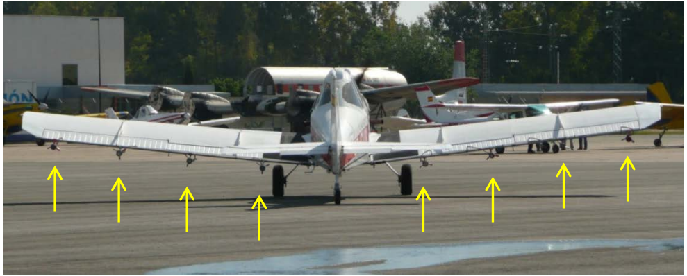
Figura 22. Simetría en el número de boquillas y equidistantes para una pulverización uniforme.
