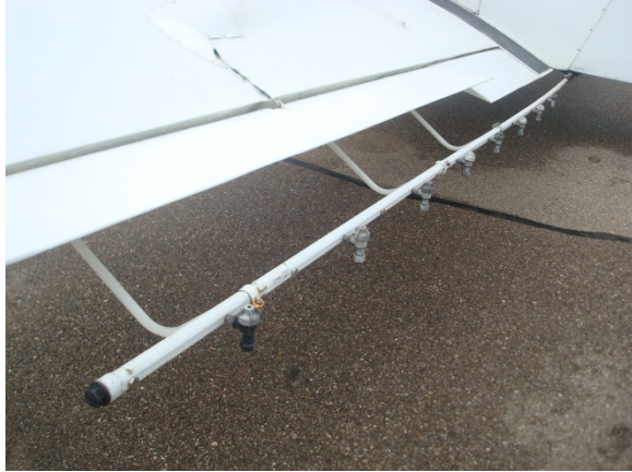
Figura 34. Pértiga con boquillas equidistantes para una pulverización uniforme a alturas inferiores a \frac{1}{3} de la envergadura del fuselaje.
