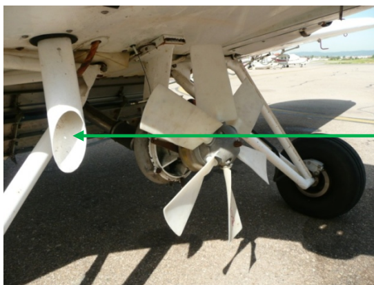
Figura 6. Dispositivo tubular de compensación de la presión interior del depósito.
