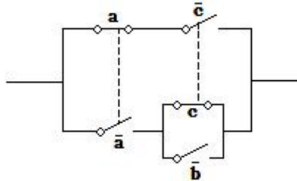
Nótese que en general, cuando la variable  $a$  a representar no está instanciada (no se asignó ningún bit/estado), se representa con un interruptor abierto, pues es más fácil de visualizar en el esquema eléctrico. Eso no significa que tal variable valga 0.
