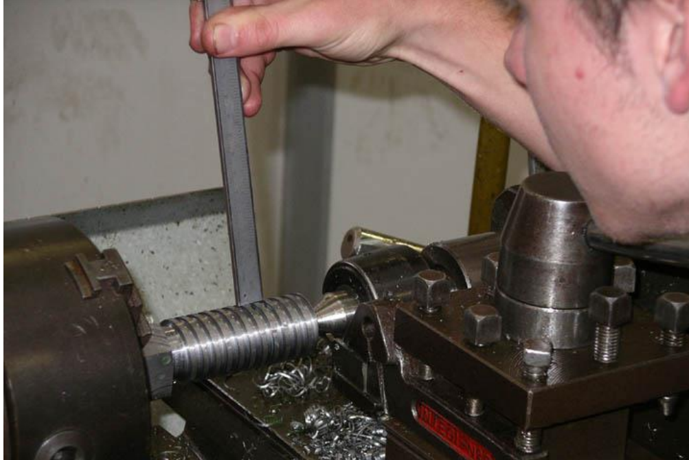
Figura 39. Torneado de una rosca en un torno convencional
