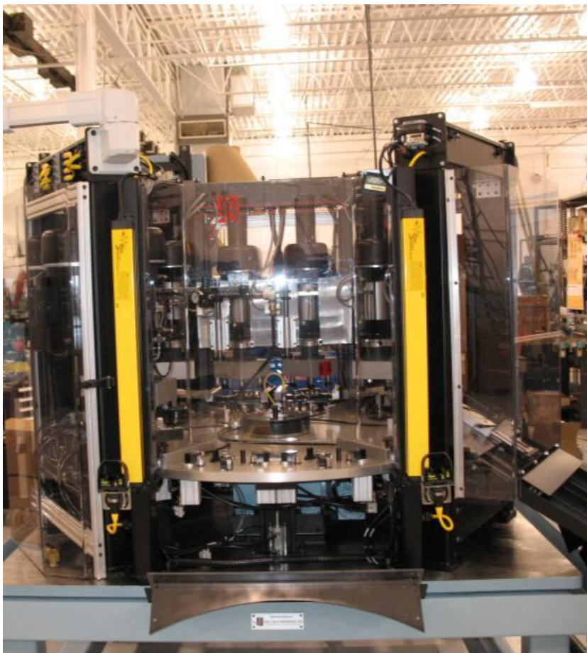
Figura 37. Centro de machueado completamente automático para machuelear varios barrenos a la vez
