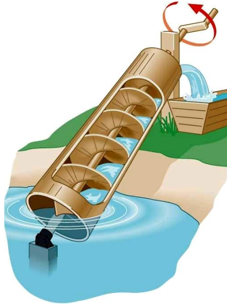
Figura 14. Tornillo de Arquímedes ( http://4.bp.blogspot.com/ )
