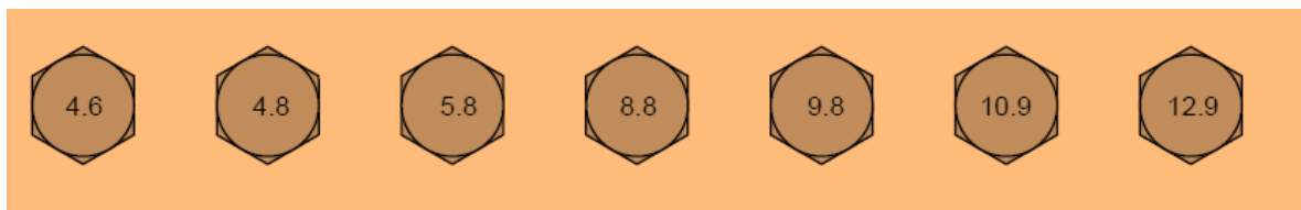
Figura 32. Marcas en las cabezas de los pernos métricos para diferentes clases
