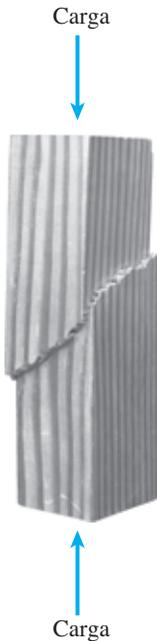
**FIGURA 2.37** Falla por cortante a lo largo de un plano a  $45^\circ$  de un bloque de madera sometido a compresión.
