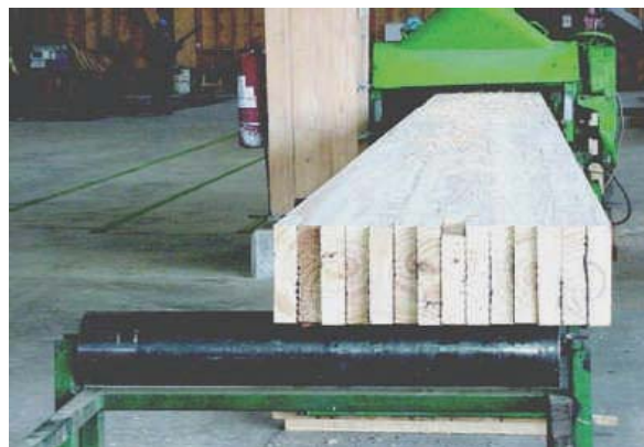
Fig. 19. Piezas unidas para conformar una viga laminada
