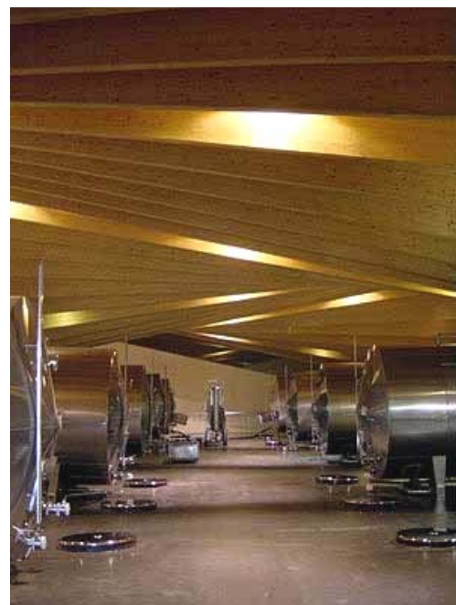
Fig. 183. Interior de la bodega. Las vigas de madera laminada de la estructura del techo se dejan vistas al interior.
