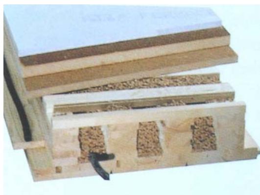
Fig. 43. Sistema Lignotrend para cubiertas, relleno con material aislante y canalización eléctrica
