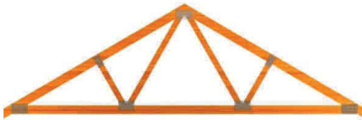
Fig. 62. Detalle de unión con placas que deben ir a ambos lados de la cercha
