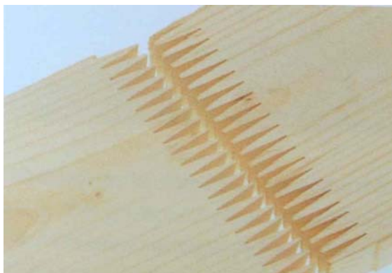
Fig. 20. Sistema de unión finger-joint
