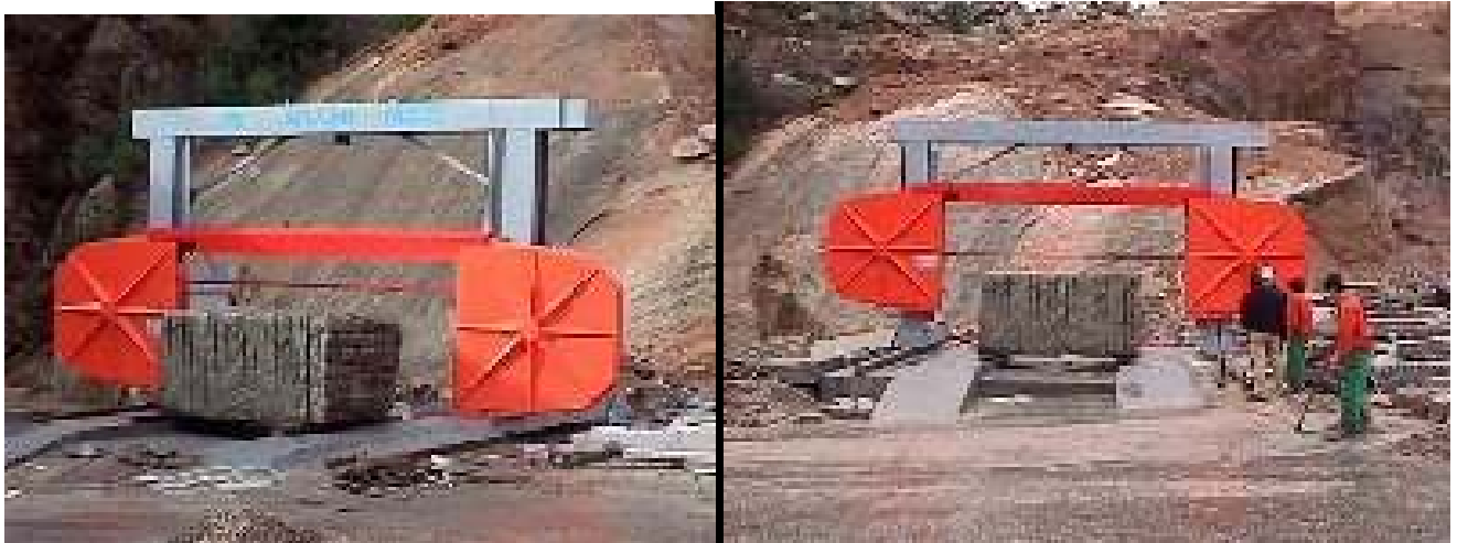
Figura 6.2.16.- Equipos principales y auxiliares empleados en las canteras de mármol.
