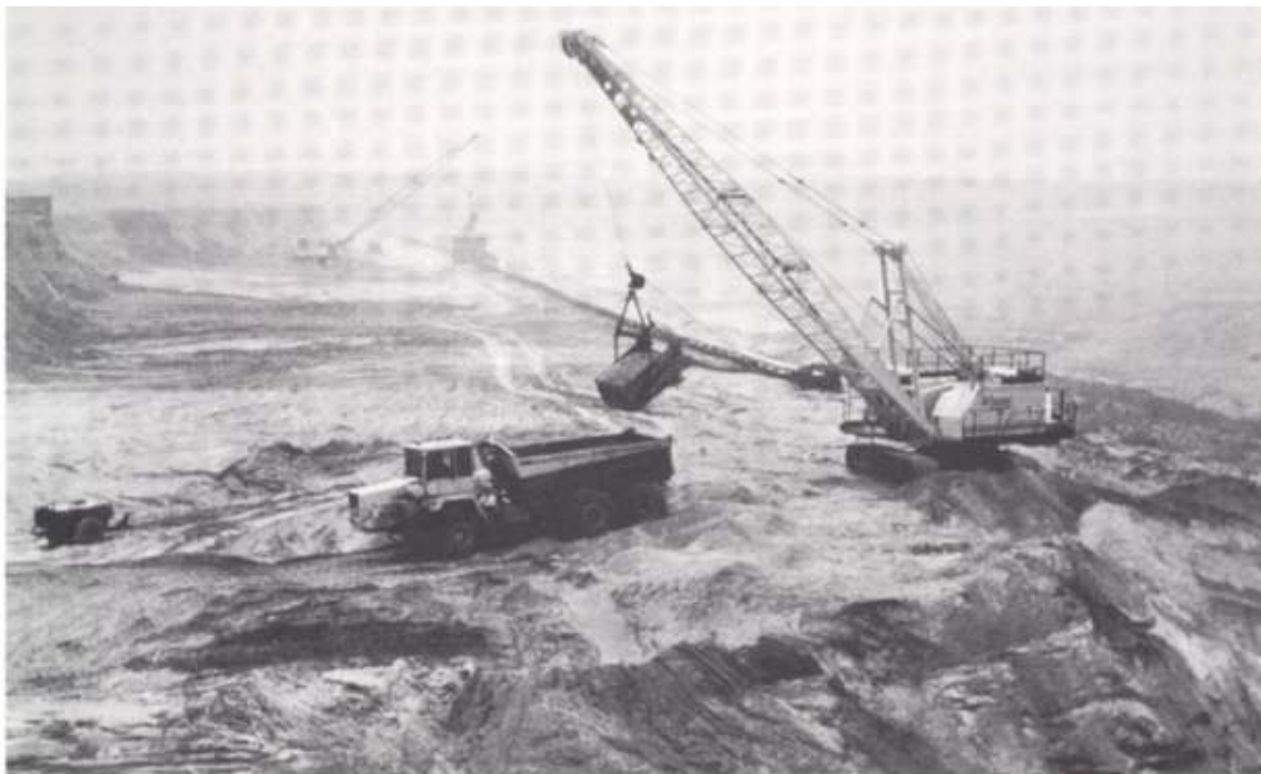
Figura 5.4.1.- Procedimientos de extracción en yacimientos de arenas, gravas y conglomerados.
