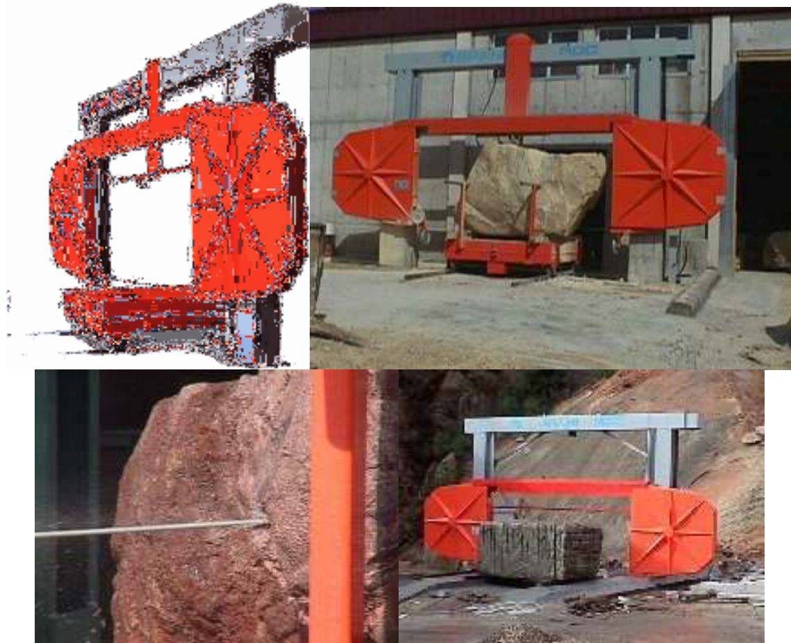
Figura 6.4.1.2.- Equipo para corte y esquadro de bloques con hilo diamantado de velocidad variable.
