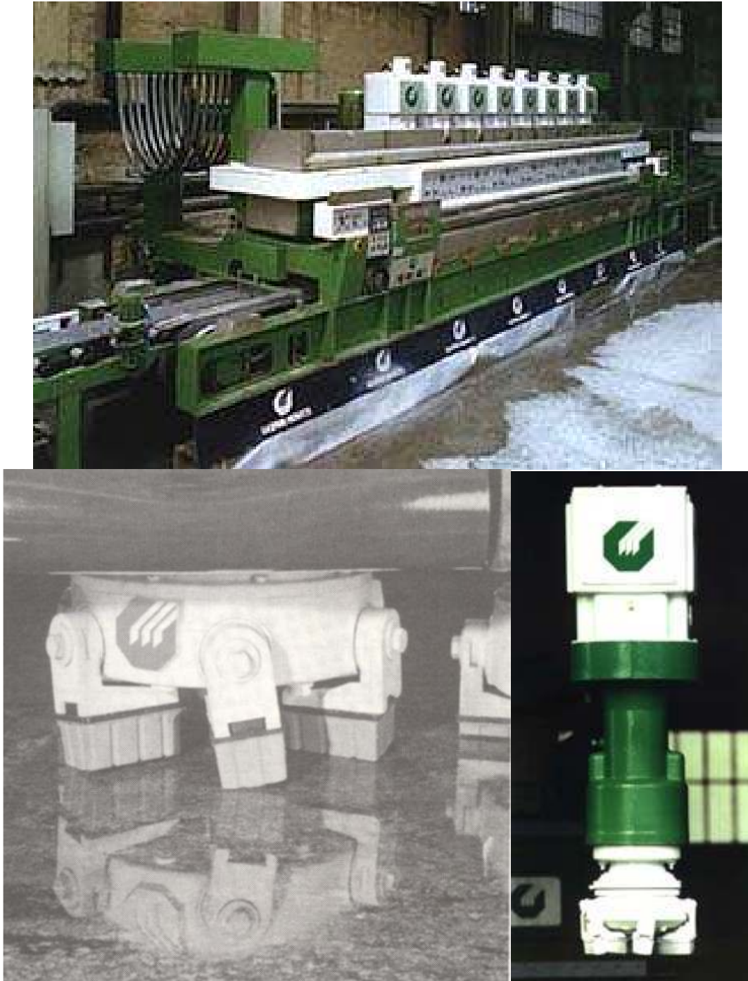
Figura 6.4.2.11.- Cabezal de pulido con 6 segmentos oscilantes
