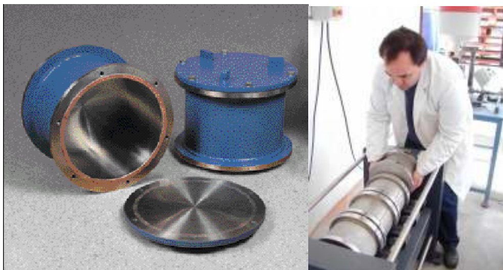
Figura 5.5.2.3.1 – Croquis y figura de un aparato tipo Micro - Deval
