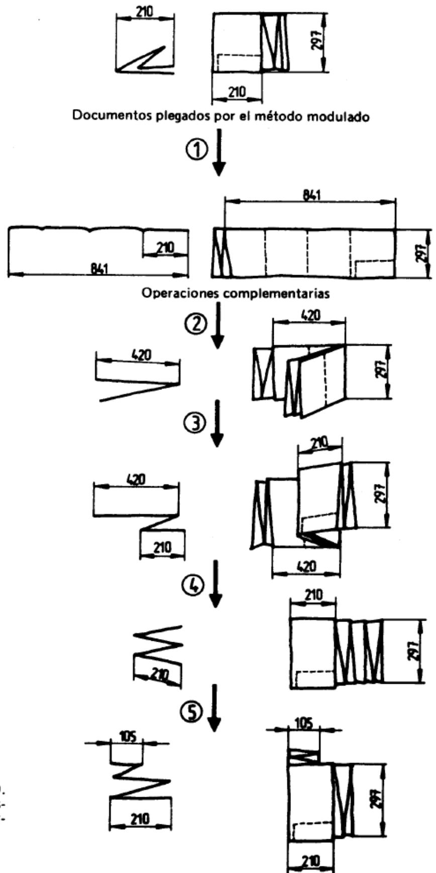
Ejemplo de plegado del formato A0. Para los otros formatos aplicar el mismo método. Para la ubicación del margen de archivado, ver figura 16A.
