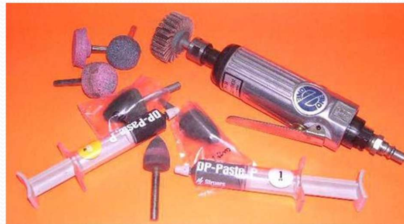
Elementos utilizados para preparar superficies metálicas con pulido mecánico.
