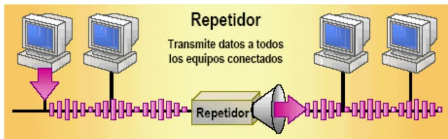
El repetidor amplificar la señal transmitida para ampliar la cobertura de la Red.
