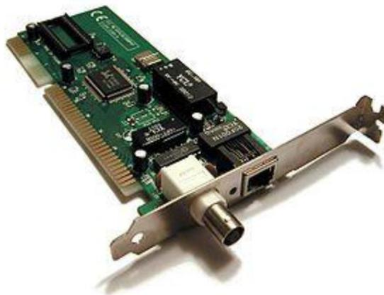
Para preparar los datos que se deben enviar, la tarjeta de red utiliza un transceptor, que transforma a su vez los datos paralelos en datos en serie. Cada tarjeta posee una dirección única denominada dirección MAC, asignada por el fabricante de la tarjeta, lo que la diferencia de las demás tarjetas de red del mundo.
