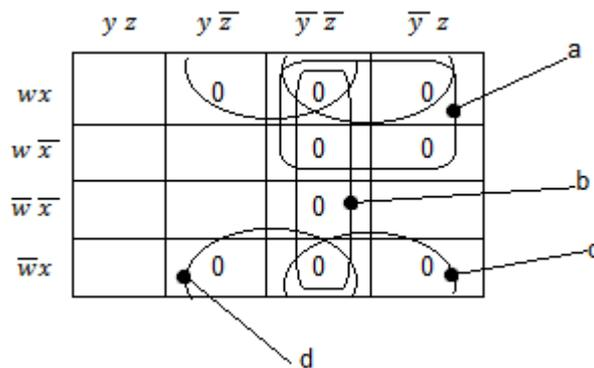
Para evitar confusiones a los distintos bloques propuestos se le asignaron letras. Así, del bloque “a” se obtiene  $w\bar{y}$ , del bloque “b”  $\bar{y}\bar{z}$ , del bloque “c”  $x\bar{y}$  y por último del bloque “d” se obtiene  $x\bar{z}$ . Se obtiene la siguiente expresión complementada debido a que se usaron las celdas de ceros no las de unos.
