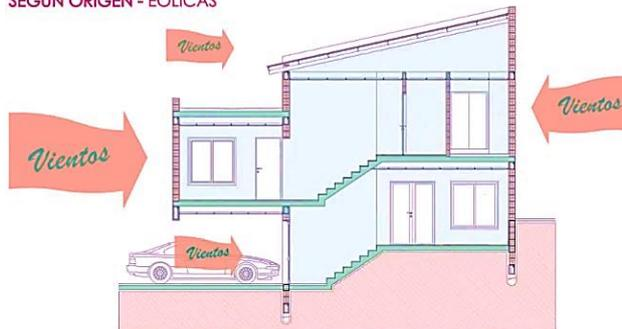
Son cargas ejercidas por acción del viento, las variables que tendremos en cuenta en las estructuras son: altura y peso, los cálculos de estructura para contrarrestar este tipo de carga tiene poca importancia en superficies de altura baja, más importancia tiene en superficies de alturas, y también lógicamente las edificaciones que estén próximos a las costas tendrán mayor carga eólica, los eventos más importantes en términos de peligro son los huracanes y tornados.
