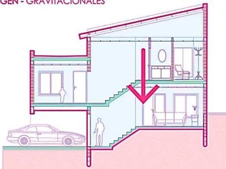
Estas cargas actúa sobre la estructura debido a la acción de la gravedad, entonces tendrán dirección vertical y tienen que ver con el peso de todo el subsistema que forman la
