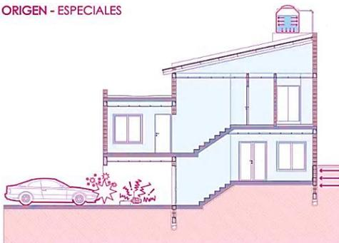
Pueden proceder de vibraciones si son de máquinas, ascensores, circulación de vehículos pesados, o de una bomba de agua como vemos en el gráfico, es importante tener presente el concepto de resonancia. La resonancia con la que tiene que vibrar ese sistema tiene que ser distinta a la del sistema natural.
